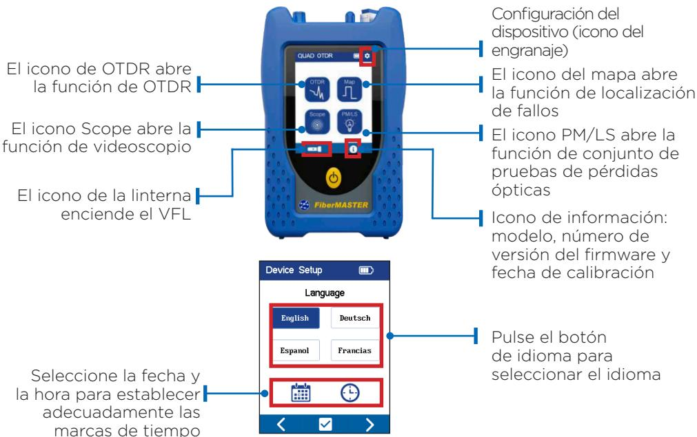
Hay uno o dos puertos OTDR disponibles. Los OTDR de onda dual tendrán un puerto, los OTDR de onda cuádruple tendrán un puerto SM y un puerto MM (2 puertos) y el OTDR PON tendrá un puerto de 1310/1550 nm y un puerto activo de 1625 nm (2 puertos). Seleccione el puerto apropiado y conecte la fibra que necesita probar.
