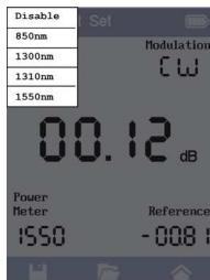
Toque el indicador de Fuente para mostrar las longitudes de onda de la fuente de luz disponibles y seleccione la longitud de onda deseada para la prueba. Deje que la fuente de luz se caliente y se estabilice durante 2-3 minutos.
