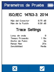
Si les paramètres sont corrects, cochez la case pour lancer le test. Une barre d'état du test s'affiche, suivie d'un message d'événement de recherche.
