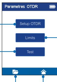
Limites permet à l'utilisateur de choisir parmi un grand nombre de normes. L'icône "Limites" pour valider les tests Pass/Echec ou de définir manuellement des seuils selon les besoins.
