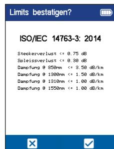
**Manuelle Grenzwerte** können im Bildschirm OTDR Limits ausgewählt werden. Zum Einstellen der Grenzwerte stehen die beiden untenstehenden Bildschirmseiten zur Verfügung (siehe Abbildung unten).
