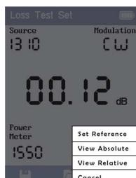
Trennen Sie die Referenzfaser vom Pegelmesser und schließen Sie eine Kupplung an. Verbinden Sie nun die zu testende Glasfaser mit der anderen Seite der Kupplung und dem Pegelmesser (siehe unten).
