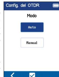
Ahora ha introducido suficiente información para realizar una prueba automática. Si selecciona Automático, el tiempo medio, el rango y el ancho de pulsos se ajustarán automáticamente en función del análisis realizado por el OTDR. Si selecciona Manual, se podrán ajustar los parámetros establecidos automáticamente en el modo Automático.
