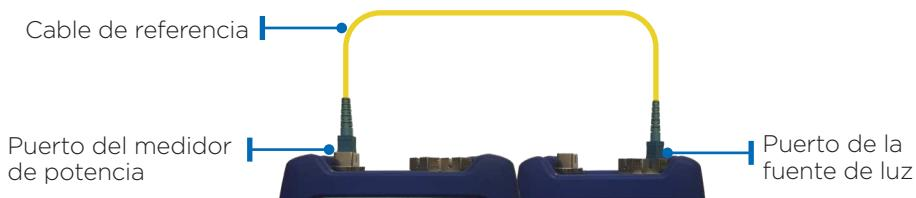
Toque el indicador de referencia en la parte inferior derecha de la pantalla y seleccione Ajustar referencia para poner a cero el cable de referencia.
