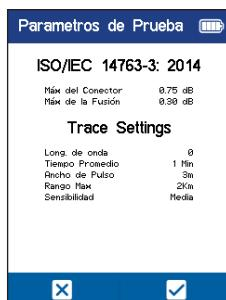
Si los ajustes son correctos, seleccione la casilla para iniciar la prueba. Aparecerá una barra de estado de escaneo, seguida de un mensaje de evento de búsqueda.
