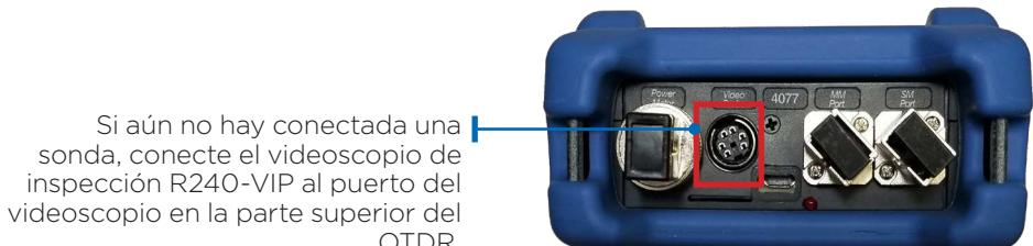
Si aún no hay conectada una sonda, conecte el videoscopio de inspección R240-VIP al puerto del videoscopio en la parte superior del OTDR.
