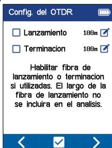
Utilice estas casillas para activar o desactivar el cable de lanzamiento o pigtail. Seleccione los iconos de edición para introducir la longitud de los cables de lanzamiento y pigtail según corresponda. También pueden establecerse en automático, en cuyo caso el OTDR establecerá el primer evento como el final del cable de lanzamiento y el penúltimo evento (el evento anterior al final) como el comienzo del cable pigtail.
