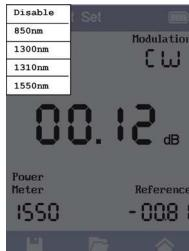
Touchez l'indicateur Source pour afficher les longueurs d'onde de la source lumineuse disponibles et sélectionnez la longueur d'onde souhaitée pour le test. Laissez la source lumineuse se réchauffer et se stabiliser pendant 2 à 3 minutes.
