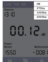
Tippen Sie im Bildschirm auf die Modulationsanzeige und stellen Sie die Modulation auf CW (Gleichlicht) ein.
