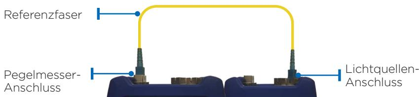
Tippen Sie am rechten unteren Bildschirmrand in die Referenz-Anzeige und wählen Sie die Option zum Setzen der Referenz aus, um einen Nullabgleich für die Referenzfaser durchzuführen.
