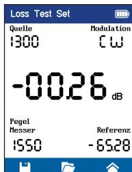
Der in der Bildschirmmitte angezeigte Wert in dB gibt die Dämpfung der getesteten Faser an.
