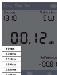
Tippen Sie im Bildschirm auf die Pegelmesser-Anzeige und wählen Sie aus den verfügbaren Wellenlängen die gleiche Test-Wellenlänge wie bei der Lichtquelle aus.
