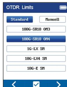
Die Standard-Grenzwerte sind markiert. Es stehen fünf Seiten mit voreingestellten Schwellwerten zur Verfügung, nach denen die Tests zur Pass/Fail-Bewertung überprüft werden.
