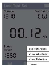
Déconnectez la fibre du port “ Power Meter”et connectez-la à une extrémité du coupleur, puis connectez la jarretière à tester entre le coupleur et le port du wattmètre, comme indiqué ci-dessous.
