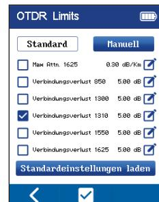
**Hinweis:** Vor der Ausführung eines Tests werden zur Kontrolle immer erst die eingestellten Schwellwerte angezeigt.
