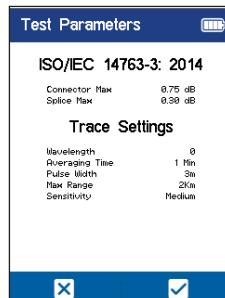
Wenn alle Einstellungen korrekt sind, starten Sie den Test, indem Sie die Checkbox antippen. Nun wird ein Fortschrittsbalken eingeblendet, dem eine Meldung zur Information über erkannte Ereignisse folgt.
