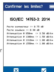
**Les limites et les seuils peuvent être sélectionnés manuellement** dans la page "Limites OTDR". Cliquez sur la flèche du bas pour passer à la page suivante.
