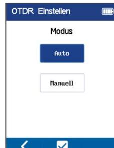
**Für diese Kurzbedienungsanleitung wird der Auto-Modus ausgewählt und zur Bestätigung anschließend die Checkbox am unteren Bildschirmrand angeklickt.**
