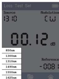
Toque el indicador del medidor de potencia para mostrar las longitudes de onda del medidor de potencia disponibles y seleccione la longitud de onda apropiada para la prueba.
