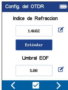
Establezca el índice de refracción si lo conoce. Seleccione Load Default si desconoce el índice de refracción (IOR) y/o el factor de hélice.
