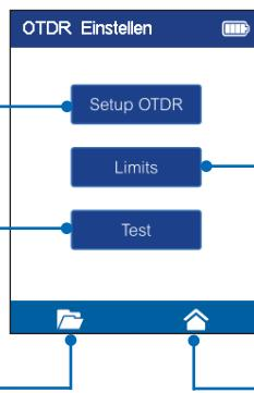
Limits ermöglicht dem Anwender, aus einer Reihe von Standards die benötigten Pass/Fail-Schwellwerte auszuwählen oder die Schwellwerte manuell festzulegen.
