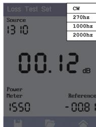
Touchez l'indicateur de modulation pour ouvrir les options de modulation et réglez la modulation sur CW pour onde continue.
