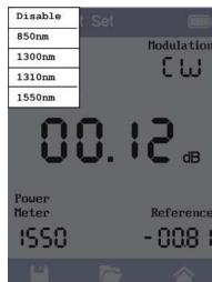
Tippen Sie im Bildschirm auf die Lichtquellen-Anzeige und wählen Sie aus den verfügbaren Wellenlängen die gewünschte Test-Wellenlänge aus. Lassen Sie die Lichtquelle 2 bis 3 Minuten aufwärmen und sich stabilisieren.
