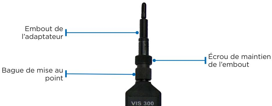
Pour retirer un adaptateur du Video Microscope, saisissez l'embout et dévissez l'écrou de maintien, comme indiqué sur l'image, tournez vers la gauche pour desserrer et vers la droite pour serrer l'écrou de l'embout du Video Microscope. Tirez l'adaptateur vers le haut. Pour placer un adaptateur sur le microscope, assurez-vous que la lentille est propre, faites glisser l'adaptateur sur l'extrémité du microscope et serrez l'écrou de maintien.
