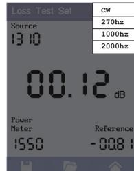
Toque el indicador de Modulación para abrir las opciones de modulación y configure la modulación a CW para la onda continua.
